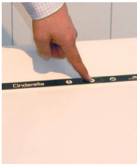
4. Lukk igjen lokket og trykk på startknappen. Når gul lampe tennes starter forbrenningen. Toalettet er nå klart til bruk igjen.
